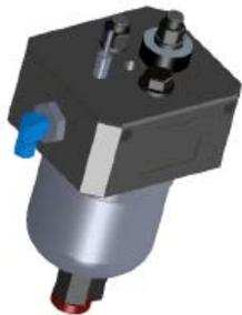
Измерительная ячейка universal fm - это герметичная изм. ячейка. Измерительная ячейка подключается таким образом, чтобы вода протекала в направлении стрелки. В ячейке находится турбина измерительной воды для измерения протока и компенсации потенциостатического измерения. Сигнал принимается через датчик Холла, который уже смонтирован на плате и подключен. Измерительные электроды устанавливаются в соответствующие отверстия измерительной ячейки).
