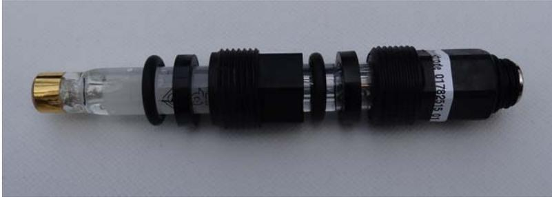
1. Снимите увлажняющий колпачок с измерительного электрода и вкрутите его в измерительную ячейку. Затяните измерительные электроды от руки (без инструмента). Расположение измерительных электродов см. на изображениях сверху.
